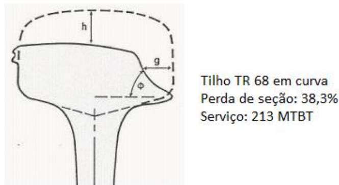
Figura 1 - Padrão de desgaste de trilho [7]
